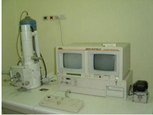
Thiết bị kính hiển vi điện tử quét Jeol 5410 LV tại Trung tâm Khoa học Vật liệu, Đại học Quốc gia Hà Nội
